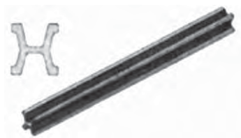
Gambar 1.6 Batang platina iridium yang digunakan sebagai meter standar, disimpan di Sevres, Paris.
