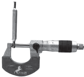
Gambar 1.13 Mikrometer memiliki skala tetap dan skala nonius.
