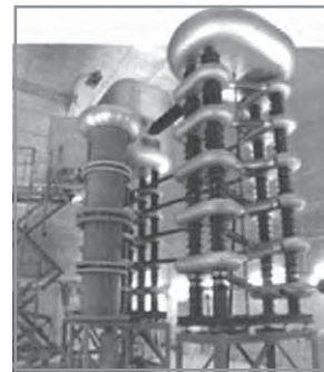
Gambar 7.10 Generator listrik Cockcroft Walton di Laboratorium Brookhaven di Long Island New York Amerika Serikat.
