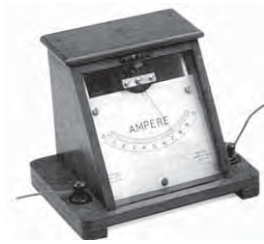
Gambar 1.16 Amperemeter untuk mengukur kuat arus.
