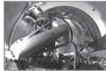
Gambar 5.16 Teleskop Hale termasuk teleskop pemantul, adalah teleskop terbesar di dunia.
