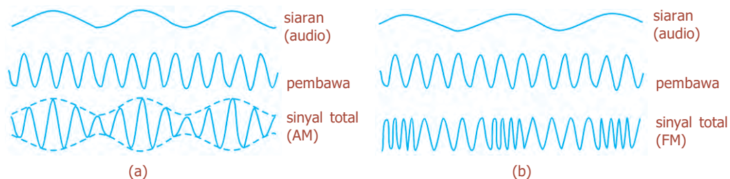
Gambar 8.11 (a) Modulasi amplitudo (AM), (b) Modulasi frekuensi (FM).
