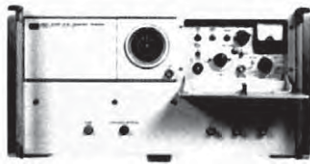
Gambar 1.8 Jam cesium mempunyai ketepatan yang sangat tinggi.
