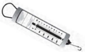
Gambar 4.2 Neraca pegas yang digunakan untuk mengukur gaya.
